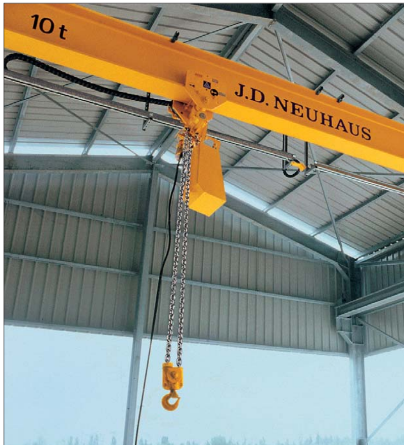
Carriponte monotrave in versione antiscintilla portata 10 t, scartamento 11 m.
